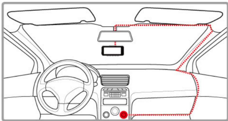
1. 電源供應器的一端連接到記錄器的 **USB** 埠。電源連接孔輸入直流電壓 **5V/1A**。
